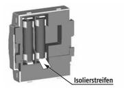
Das Gerät wird mit eingelegten Batterien ausgeliefert. Zwischen einem Batteriepol und dem Kontakt ist ein Isolierstreifen eingelegt, der vor der Montage entfernt werden muss!
