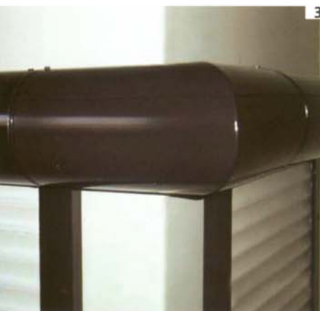
Abb. 3: Einfache Montage, da die Gehrungsecke über die Lagerhalterungen geschoben und mit Schrauben befestigt wird.
